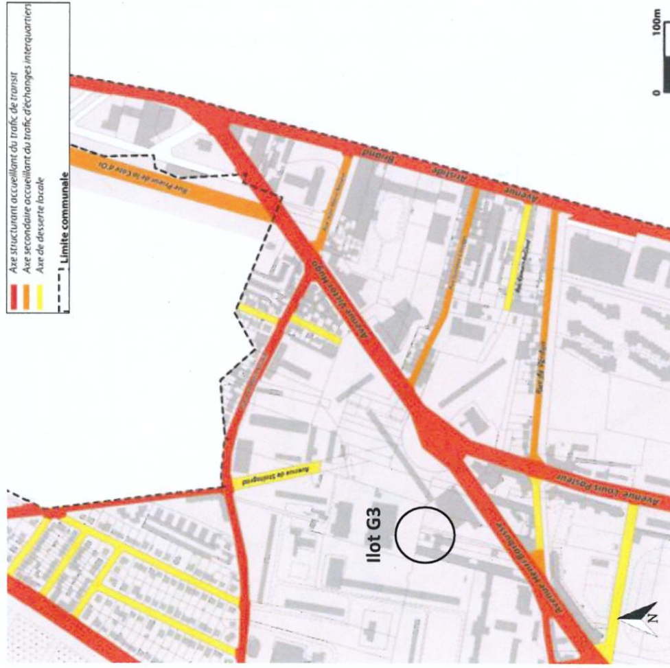
Hiérarchisation du réseau de voirie avant les chantiers gares (en 2011)
