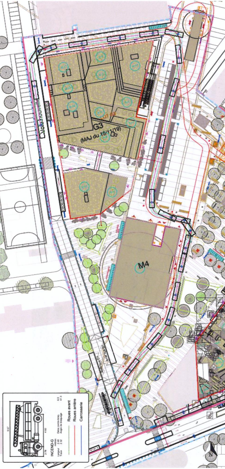
Exemple de rotation de véhicules particuliers (véhicule de pompier)
