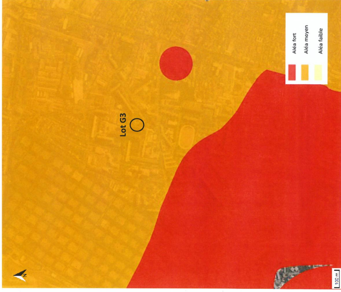
Risque aléa retrait-gonflement des argiles sur le site G3
