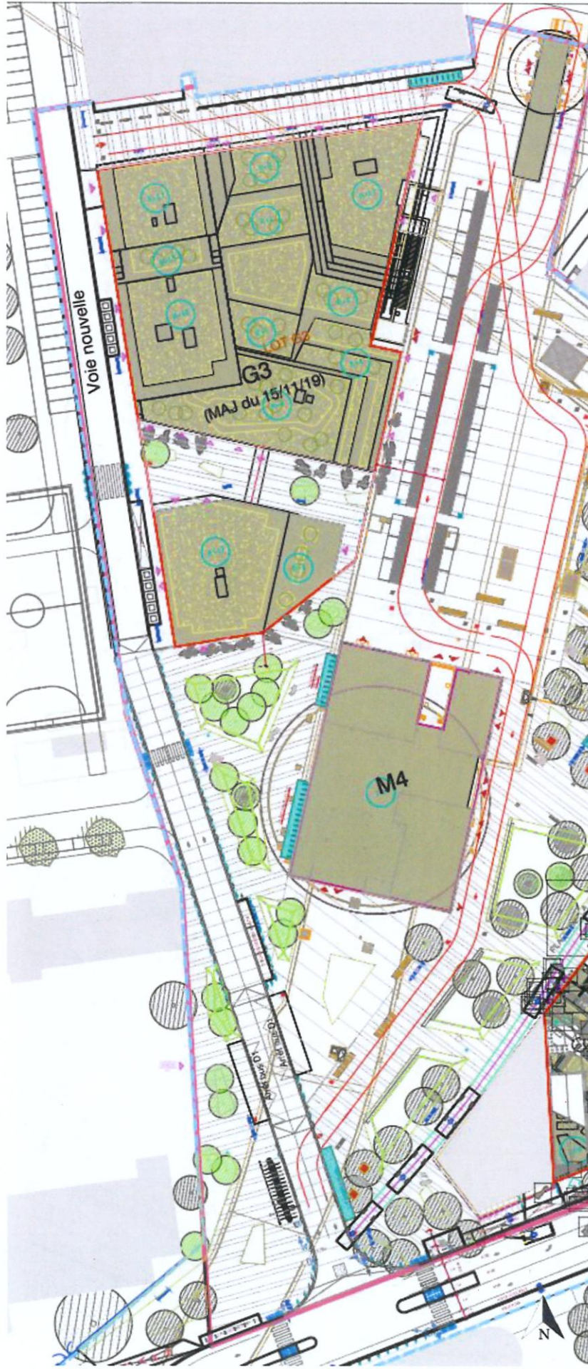
Épure de giration de la voie nouvelle à l'Ouest de l'îlot G3
